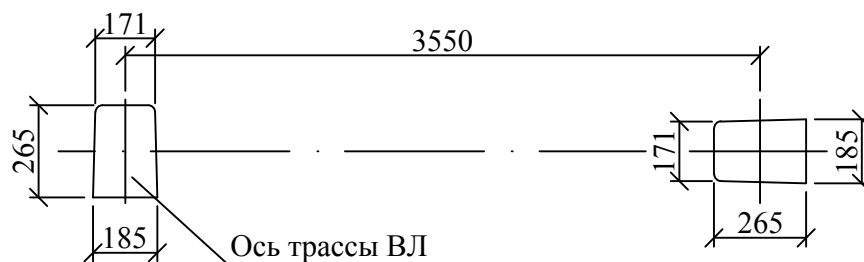
Схема установки стойки СВ95-3 (СВ95-3с)
