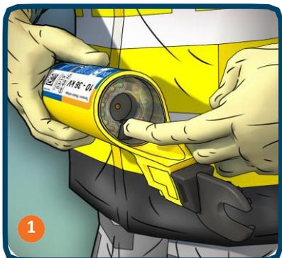
■ Проведите самодиагностику для проверки состояния батареи и надлежащего функционирования прибора.
