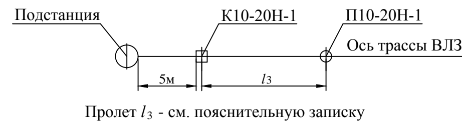
Схема 1 установки на ВЛЗ А10-20Н-1 в качестве анкерной опоры
