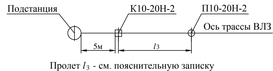
Схема 2 установки на ВЛЗ К10-20Н-2 в качестве концевой опоры
