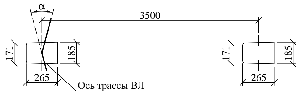
Схема установки стойки СВ95-3 (СВ95-2с, СВ95-3с)
