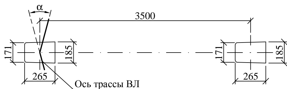
Схема установки стойки СВ95-3 (СВ95-2с, СВ95-3с)
