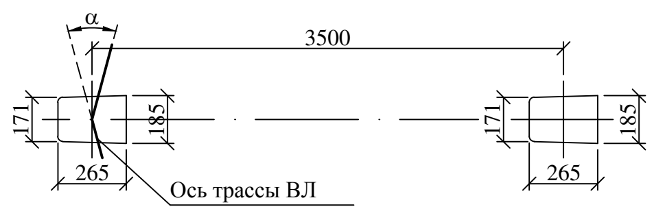
Схема установки стойки СВ95-3 (СВ95-3с)
